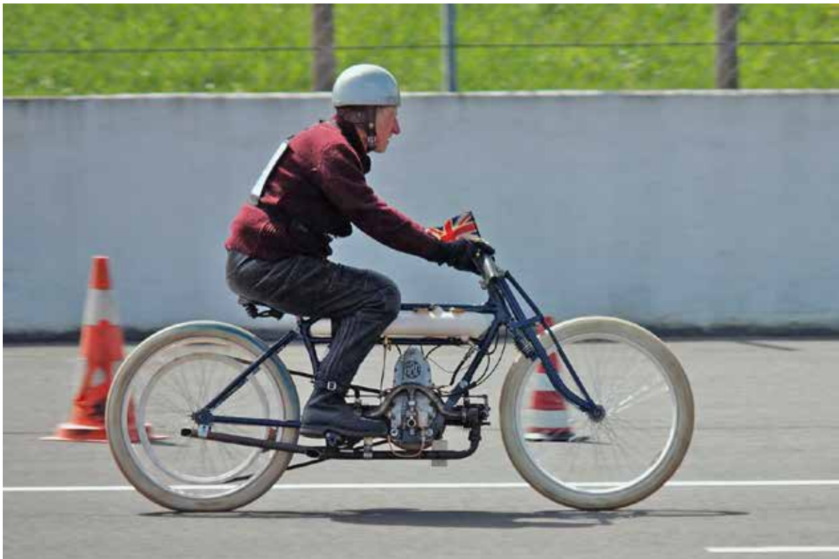
Toujours au Vintage Revival, un mix d'époque avec un moteur de 1913 type C et une transmission directe dans un cadre Douglas de 1914. Et ça marche fort ! (photo F-M. Dumas)
