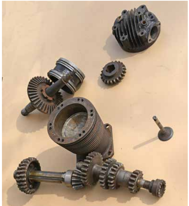
Cylindres tournés dans une barre d'acier, culasse en fonte et sur ces dernières versions Gnome & Rhône, pistons en alu à calotte concave. Les quatre rapports de la boîte sont eux aussi, tout à fait exceptionnels. (photo F-M. Dumas)
