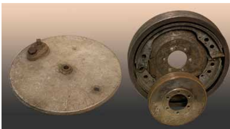
La partie cycle est tout aussi novatrice avec ses suspensions avant et arrière voire avec son side-car à roue suspendue, et bien sûr ses freins à tambour ailetés en fonderie. Sur la 400 cm 3 ils ont un diamètre de 125 mm à l'avant et de 165 mm à l'arrière, mais sur les 500 utilisées en course ont le plus souvent un 165 mm à l'avant avec parfois à l'arrière le monstrueux 220 mm que vous voyez ici comparé au 125 mm posé devant. (collection Jean-Claude Conchard)
