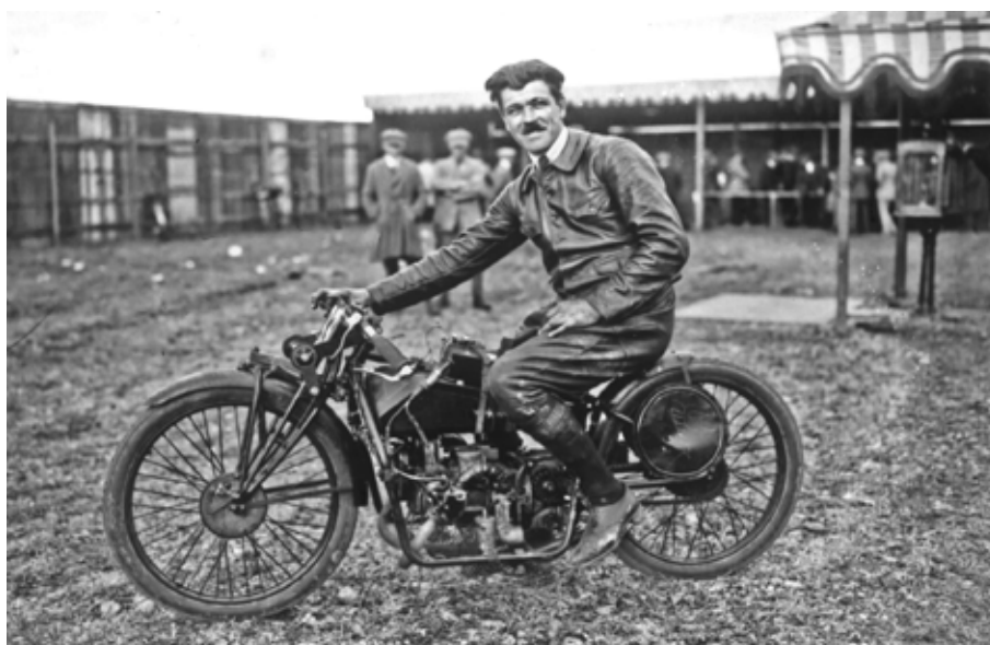
Henri Naas au GP de l'ACF à Lyon en 1924 avec une 500 ABC bien spéciale à cadre sans suspension arrière, réservoir d'huile supplémentaire et deux volumineux carburateurs. (archives E. Favre)
