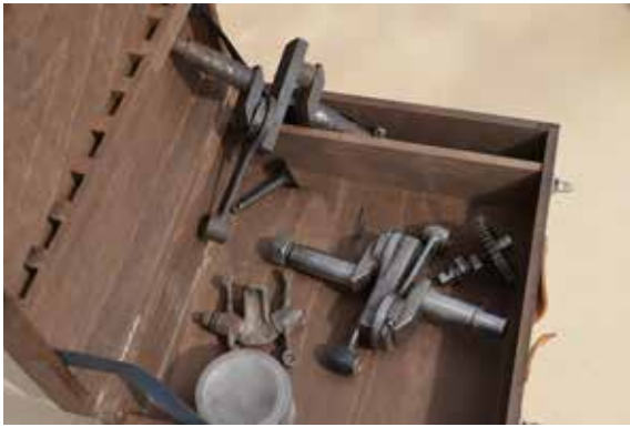
Les frêles dimensions du vilebrequin sont impressionnantes... et ça tourne à 6000 tr/min ! (photo F-M. Dumas)
